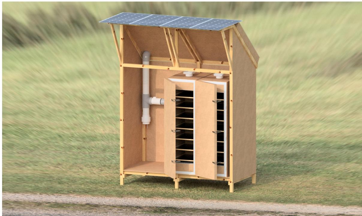
Un séchoir solaire hybride est conçu pour exploiter principalement l'énergie solaire, tout en intégrant des sources d'énergie secondaires (électrique, biomasse, etc.) pour conditionner l'air nécessaire au séchage des aliments. Ce type de séchoir est particulièrement adapté aux conditions climatiques variables, lorsque l'énergie solaire seule ne suffit pas.
